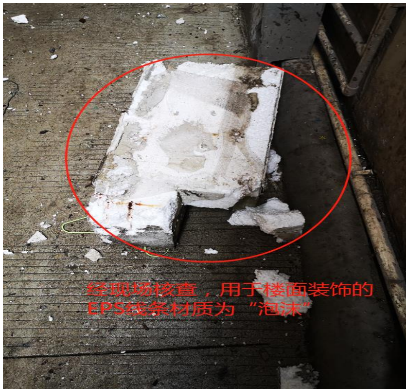
(图四) 事发现场发现，EPS线条材质为“泡沫”。
